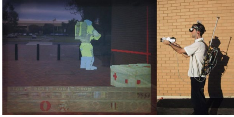
Şekil 2.10. ARQuake için tasarlanan giyilebilir bilgisayar ve şeffaf başlık seti [14].
