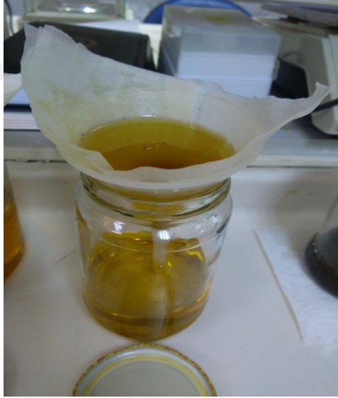
Şekil 3.1. Çalışmada kullanılan nar çekirdeği yağının filtrasyonu
