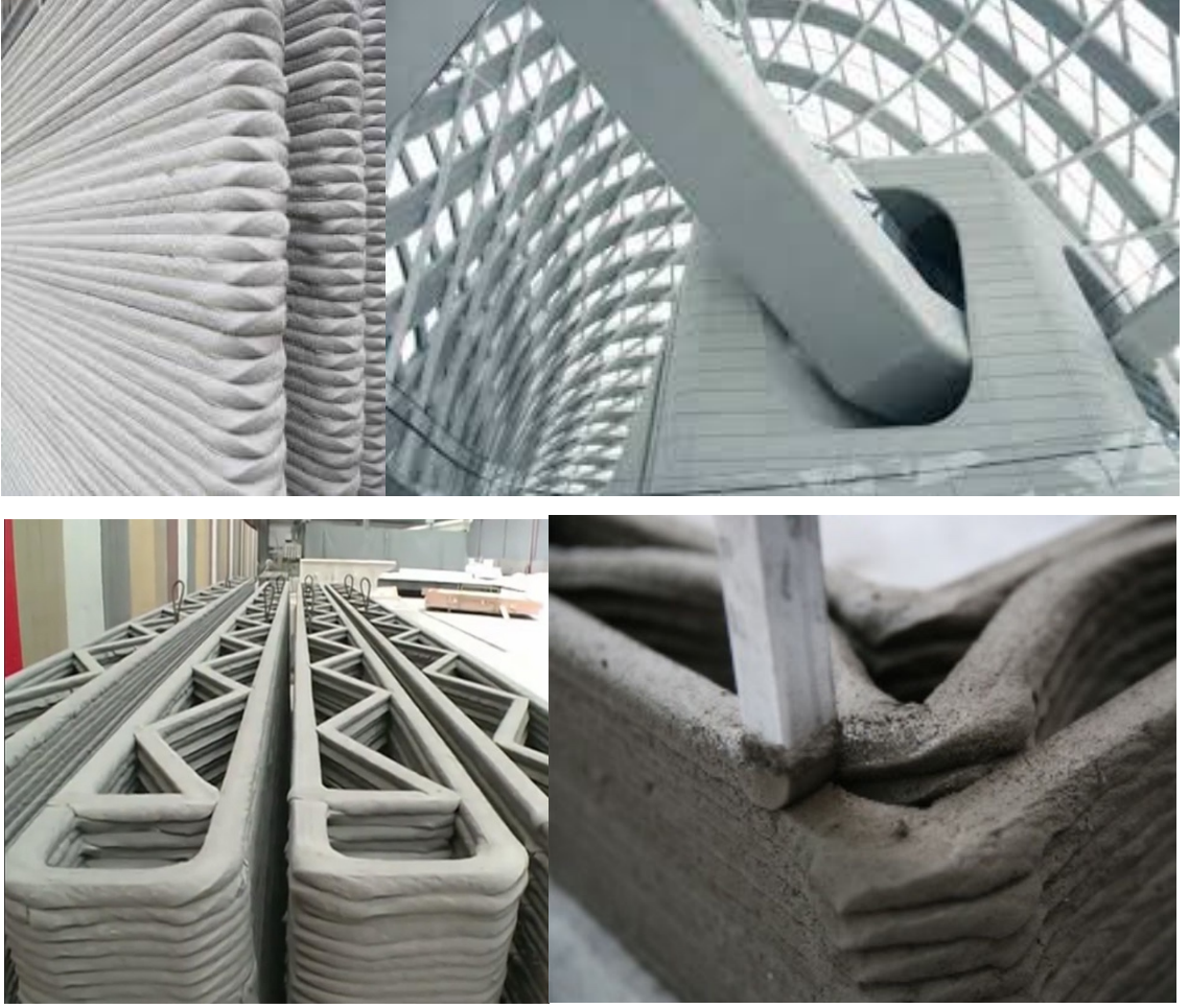
Şekil 2.25. 3B Yazıcı ile basılmış yapı elemanları [56].
