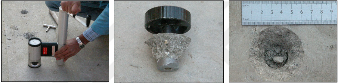
Şekil 2.49. Beton bloklar üzerinde, yüzeyde kopma dayanımı deneyinin yapılışı [80].
