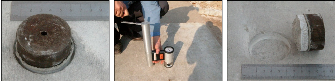
Şekil 2.52. Doğrudan çekme dayanımı deneyi yapılışı [80].
