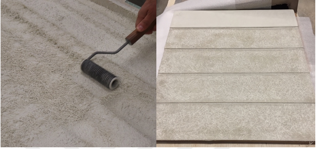
Şekil 2.12. AR Cam lifi takviyeli beton içinde liflerin dağılımı.
