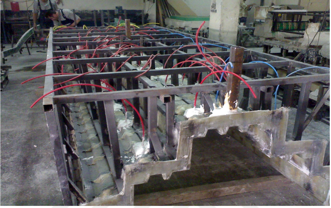
Şekil 2.16. Poliüretan kalıp dış destek ünitesi hazırlanması.
