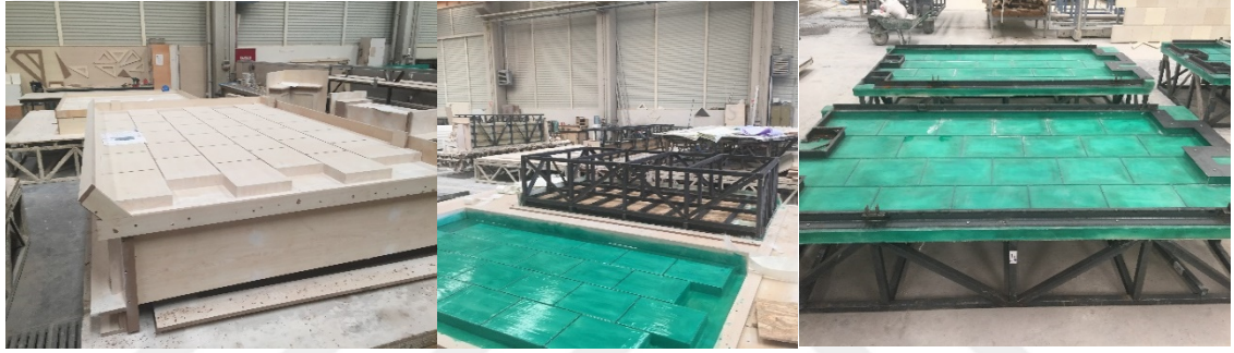
Şekil 2.15. Polyester kalıbın tasarımı ve yapım aşamaları.
