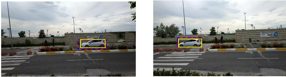
Şekil 5.13 : MobileNet SSD + İvmeölçer ile 5. ve 26. video karelerinde yapılan nesne tespiti.
