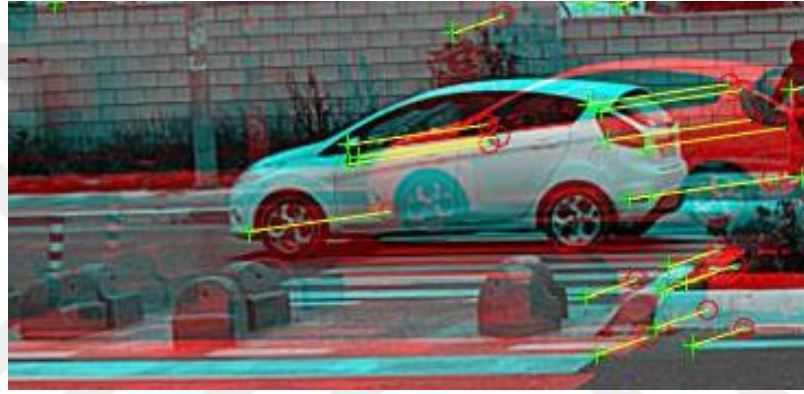
Şekil 3.7 : İki ardışık video karesi arasındaki eşleştirilmiş köşeler.
