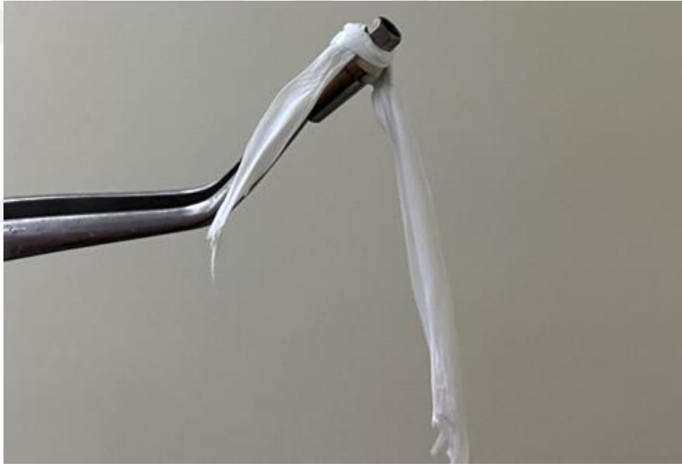
Şekil 3.12: Teflon Bant Uygulaması
