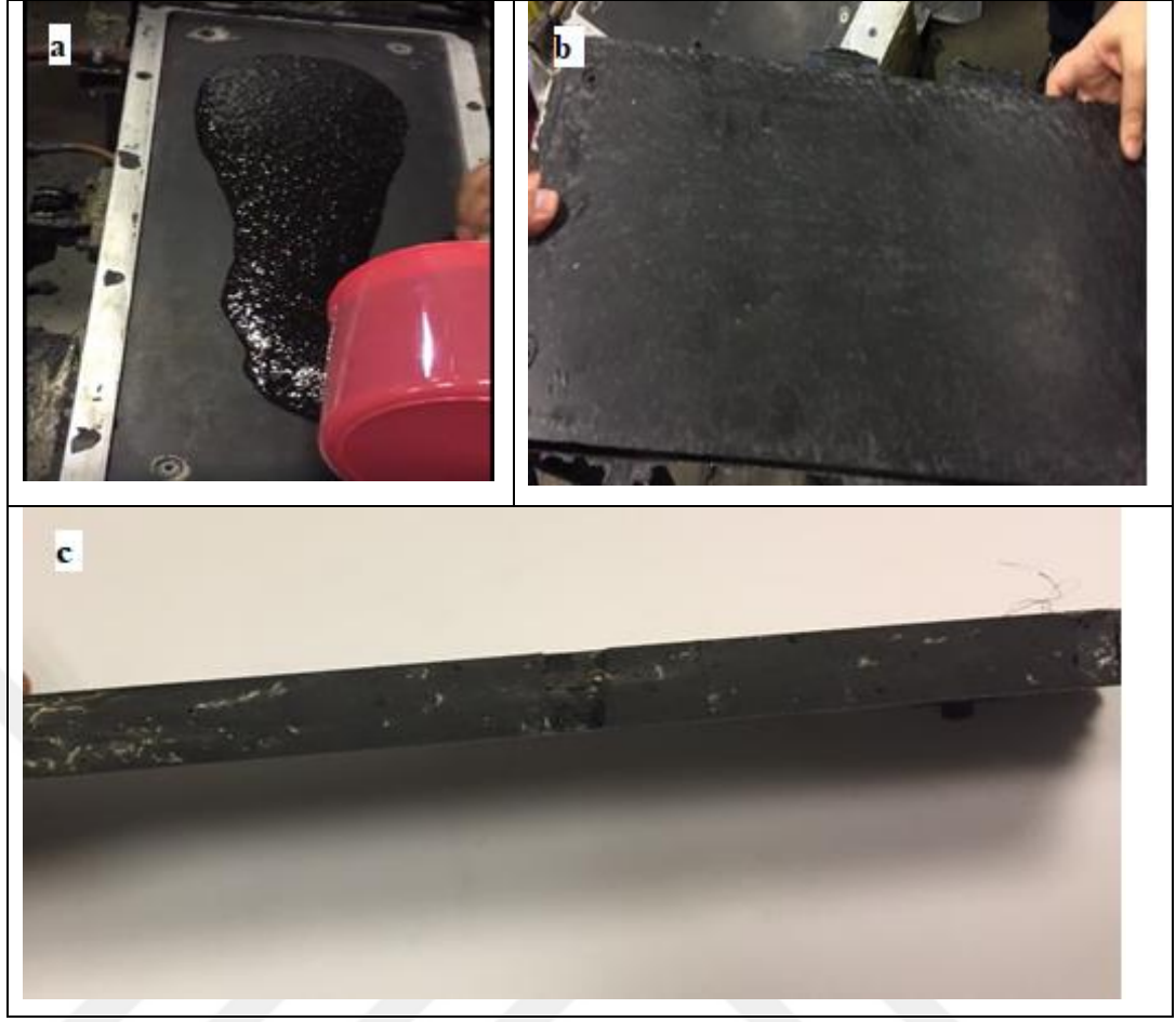
Şekil 4.35: Keten kütük elyaf takviyeli poliüretan kompozitin oluşturulması. a) elyafın kalıp içerisinde dağılımı, b)ürün, c)kompozitin enine kesiti
