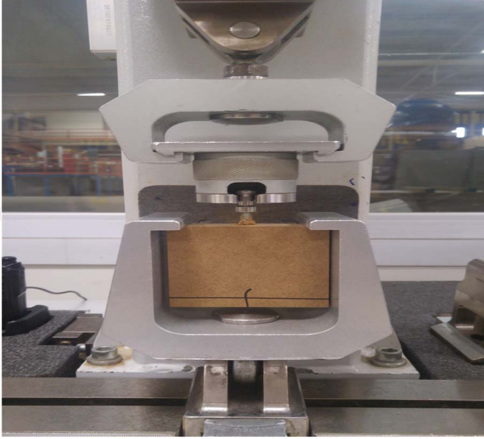
Şekil 3.4. Test Cihazında Vida Tutma Testi
