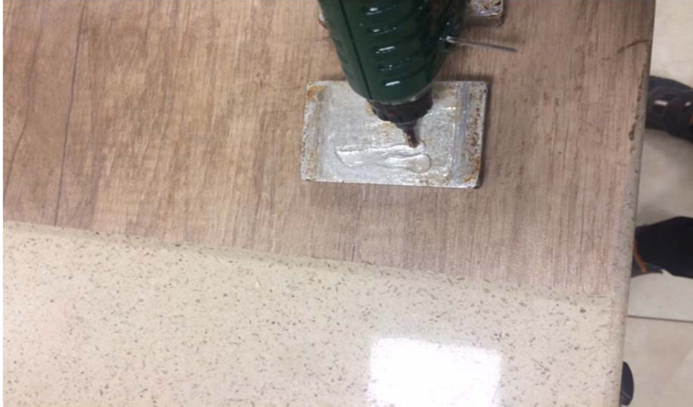
Şekil 3.6. Isıtılmış Plakalara Silikon Sıkılması
