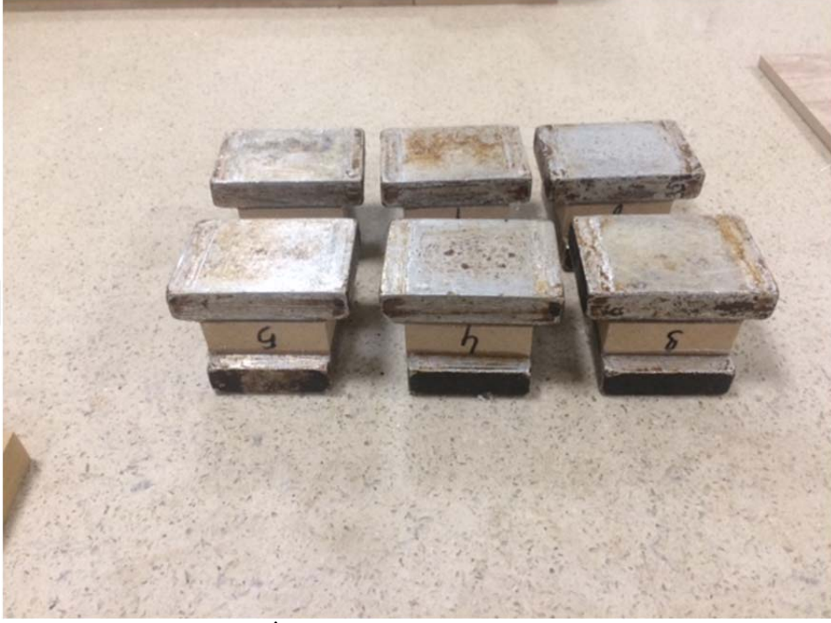
Şekil 3.7. Isıtılmış Plakalar İle Numune Levhaların Yapıştırılması
