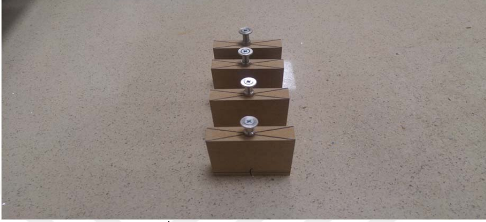
Şekil 3.3. Vida Tutma Testi İçin Vidalanan Numune Levhalar
