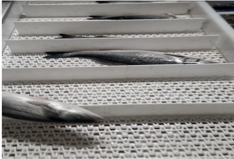
Şekil 4.1.5. Boylama (kalibrasyon) makinesi (orijinal)
