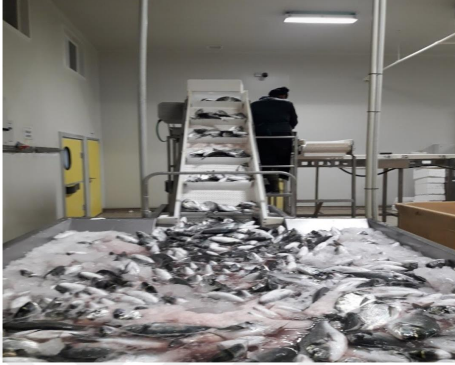
Şekil 4.1.4. Boylama (kalibrasyon) makinesi (orijinal)
