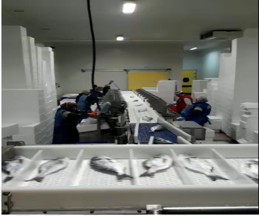
Şekil 4.1.6. Boylama (kalibrasyon) makinesi (orijinal)
