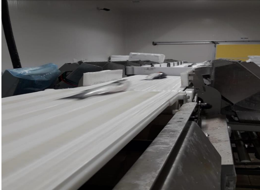
Şekil 4.1.7. Boylama (kalibrasyon) makinesi (orijinal)
