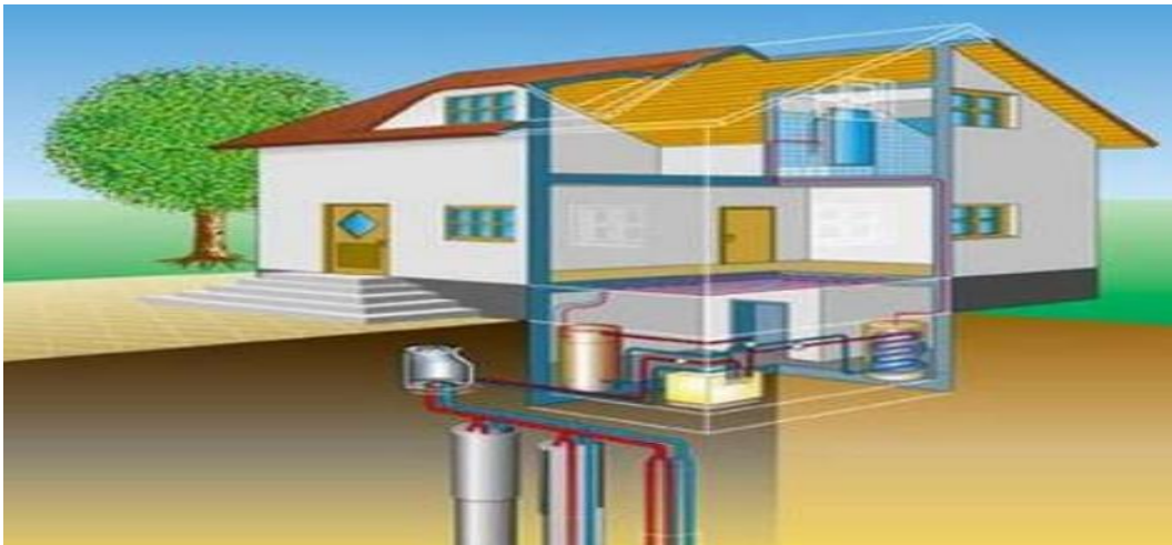
Şekil 3.6. Dikey tip toprak kaynaklı ısıtma şeması.
