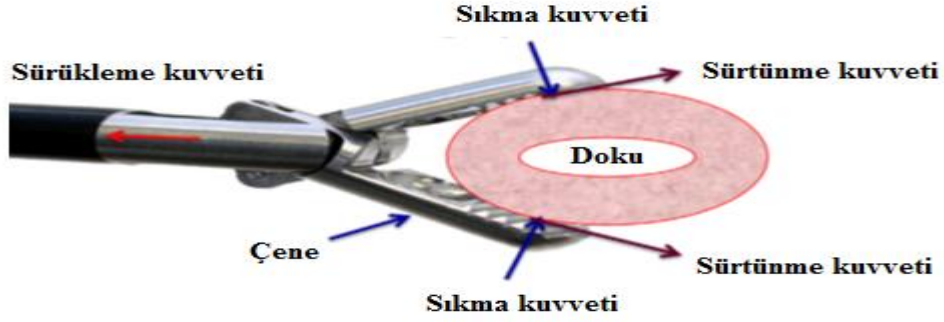
Şekil 2.4. Tutucu-doku etkileşiminin mekanik analiz şeması [33].
