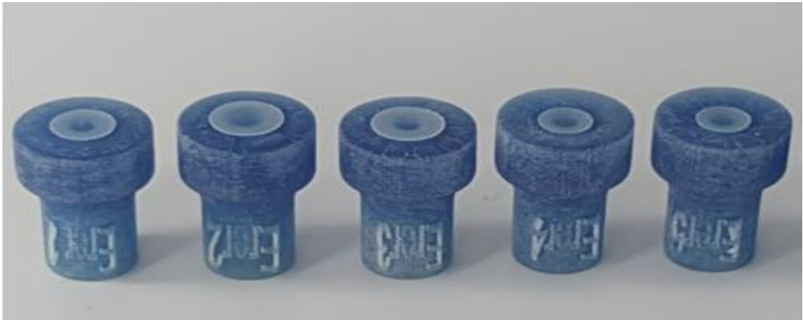
Şekil 6.2. Temassız tutucu prototip fotoğrafları.
