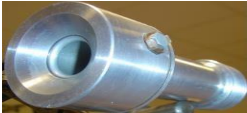
Şekil 5.10. Silindirik coanda ejektör [81].
