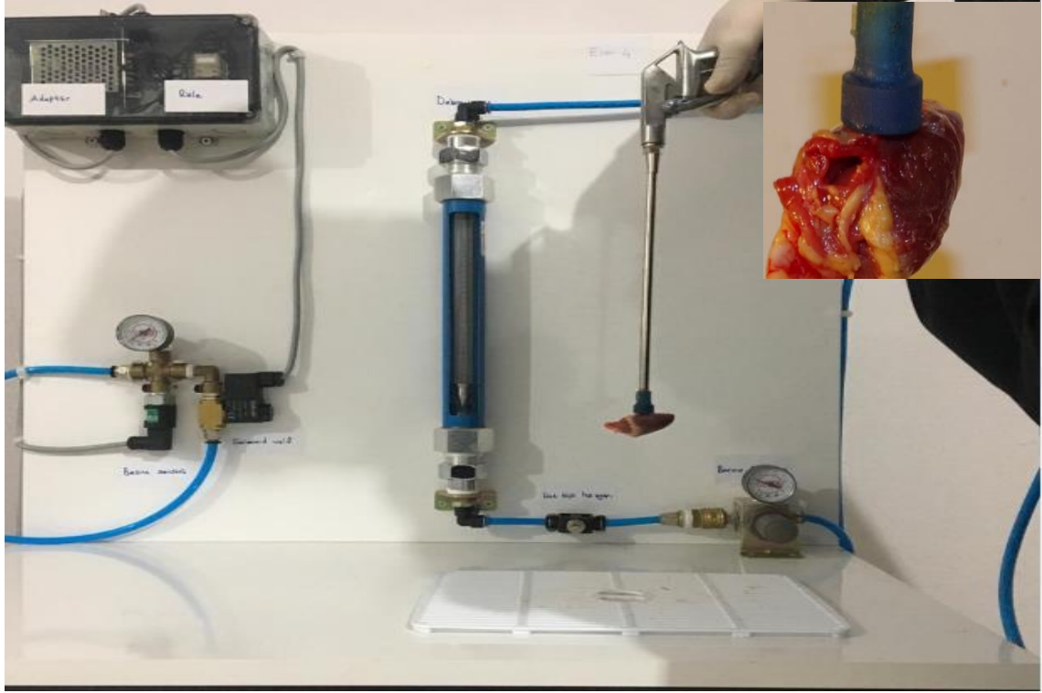
Şekil 8.20. Erer 4 tutucu ile yüreğin kaldırılması.
