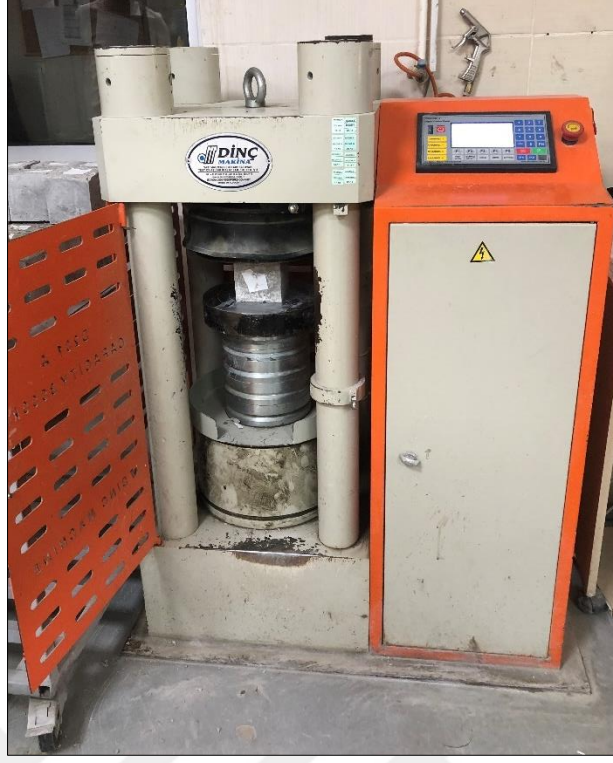
Şekil 4.6: Basınç dayanımı ölçümü esnasında numunenin görüntüsü.
