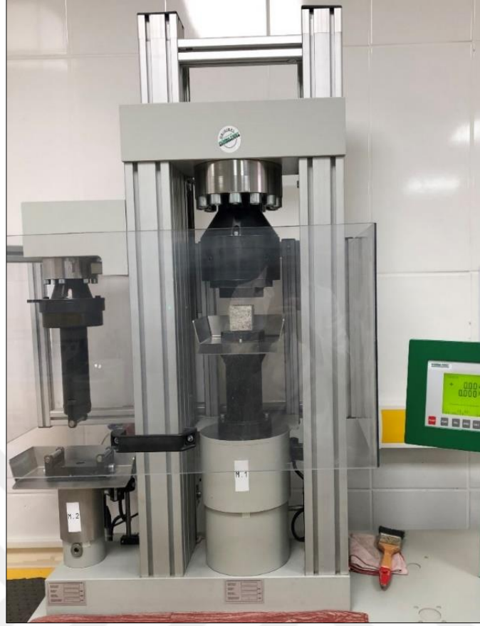
Şekil 4.4: Harç pres makinesi ve test esnasında numunenin görüntüsü.
