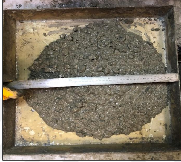
Şekil 4.5: Yayılma testi esnasında numunenin görüntüsü.
