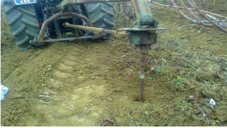
Şekil 3.12. Toprak nem ölçümleri (Alço 2014, orijinal fotoğraf)
