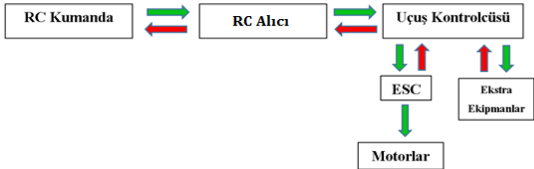
Şekil 3.8. Kumanda, alıcı ve uçuş kontrolcüsü ilişkisi.
