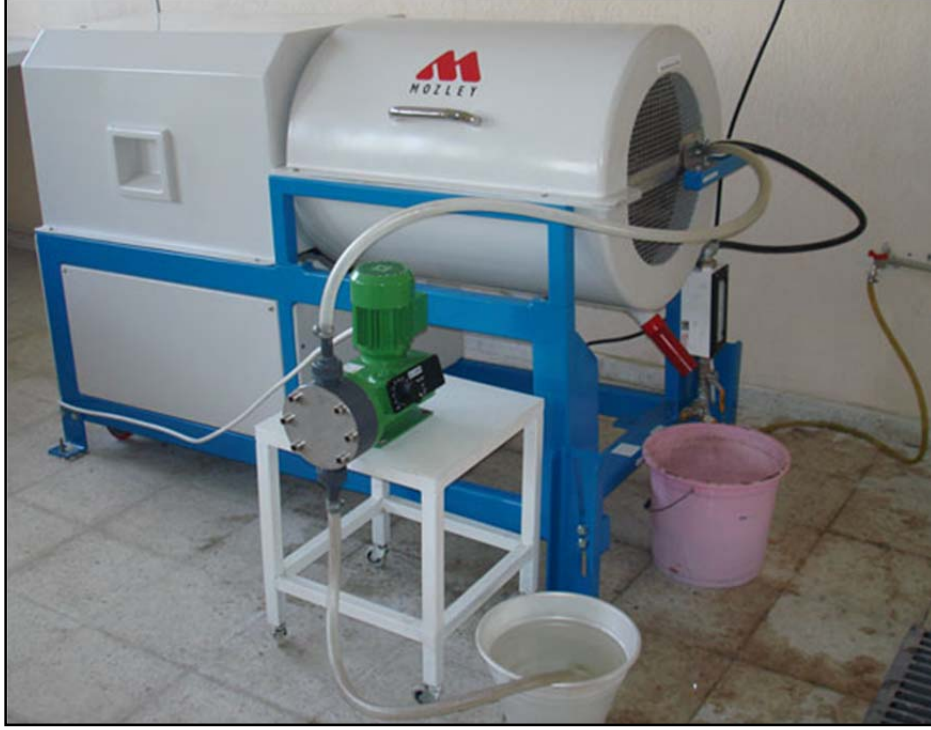
Şekil 5.4. Deneylerde Kullanılan Pilot Ölçekli C900 Laboratuvar Tip Mozley MGS Cihazı (Afyon Kocatepe Üniv. Lab.)
