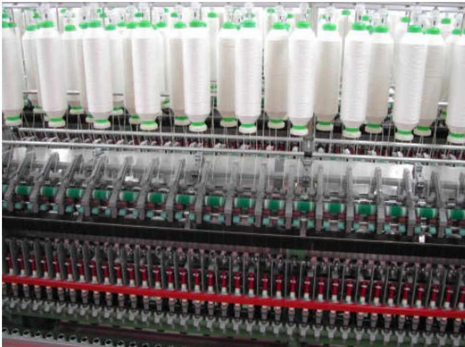
Şekil 1.3. Ring iplik makinesinin önden görünüşü
