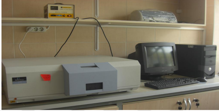
Şekil 2.2. Fotolüminesans ölçümleri için kullanılan cihaz.
