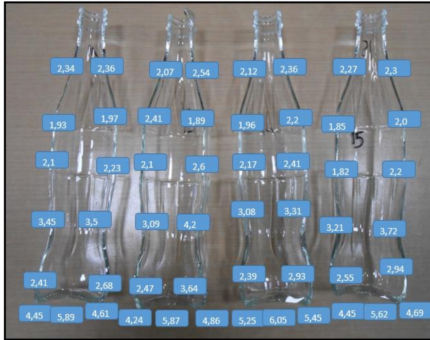
Şekil 3.10: Kesit alınmış bir cam ambalaj ürününün cidar kalınlığı dağılımı.
