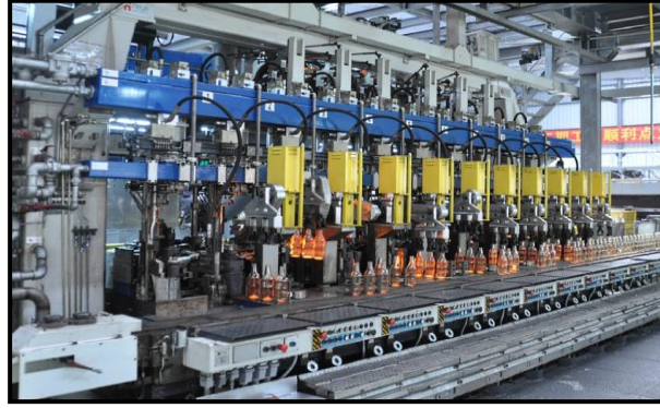
Şekil 3.5: Cam ambalaj üretiminde kullanılan 10 kollu IS makinesine ait bir görüntü.
