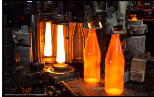
Şekil 3.8: Şişelerin “alıcı maşa” yardımı ile “finişör kalıbından” alınarak “dead plate” üzerine bırakılma görüntüsü.
