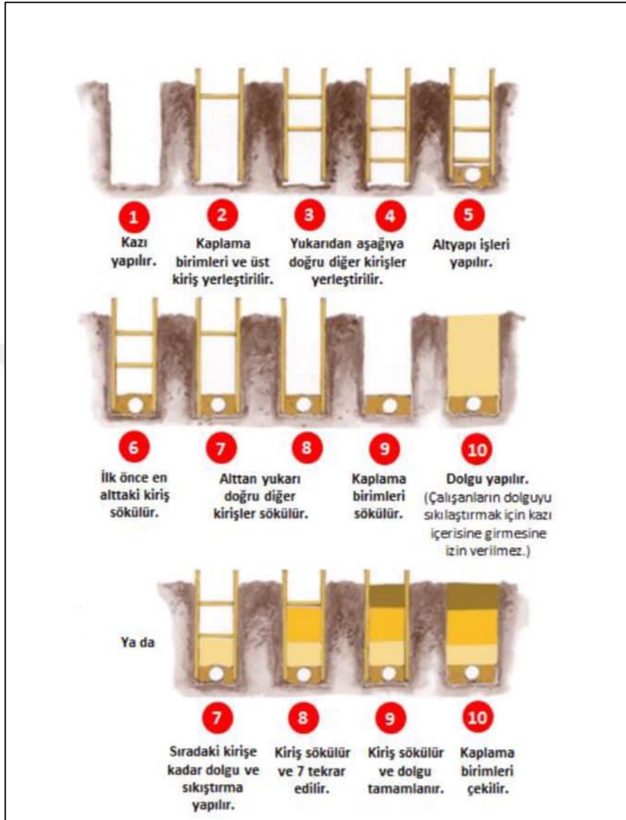
Şekil 11: İksa yapımı ve sökümü[15]
