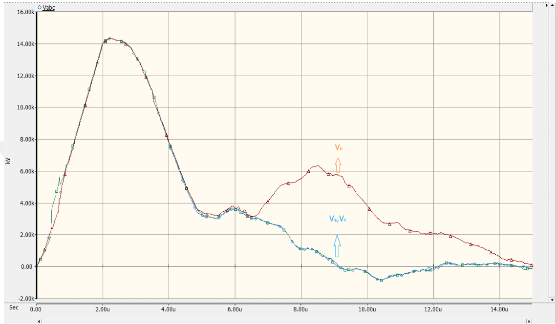
Şekil 4.8. Direncin 2000\Omega olması durumunda fazlar arası gerilim karşılaştırması
