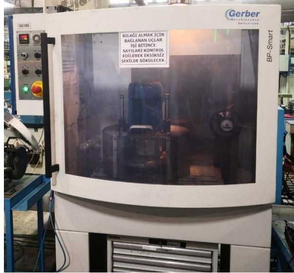
Şekil 4.6. Gerber kesme kenarı hazırlama tezgahı.
