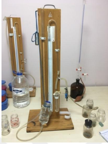
Şekil 3.6. Scheibler Kalsimetresi ile kireç ölçümü
