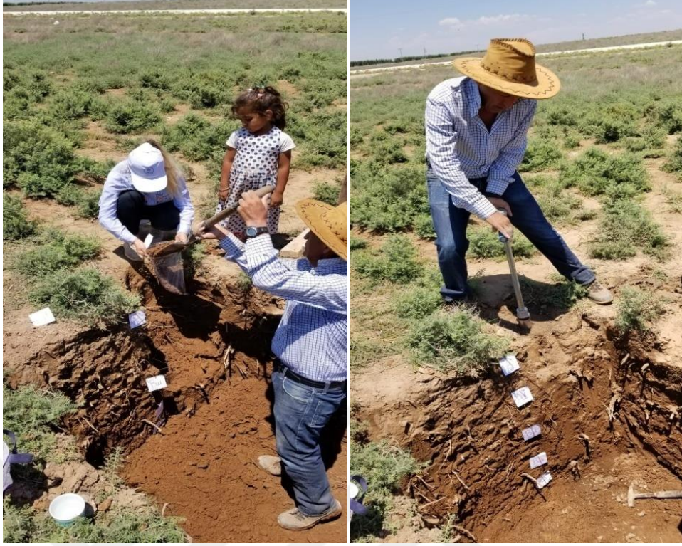
Şekil 3.3. Bozulmuş ve bozulmamış toprak örneklerinin alınması
