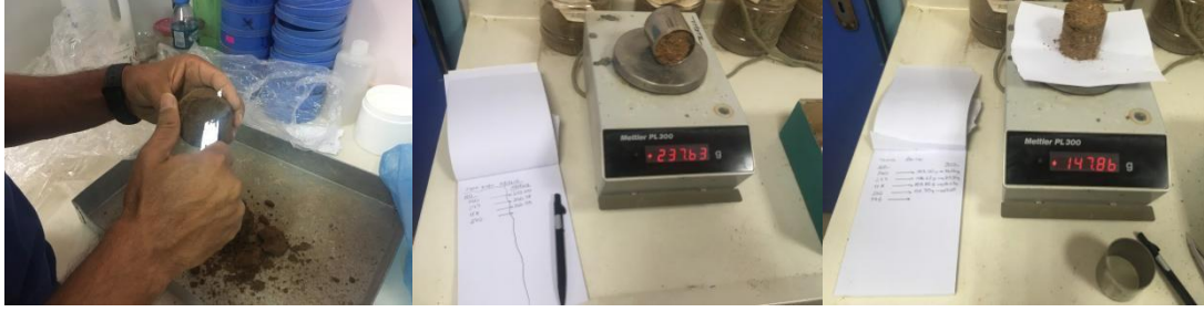
Şekil 3.9. Bozulmamış toprak örneğiyle hacim ağırlığı hesaplama
