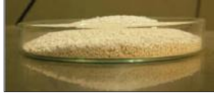
Şekil 2.14. P-ROC prosesinden elde edilen ürün (Petzet ve Cornel, 2009)
