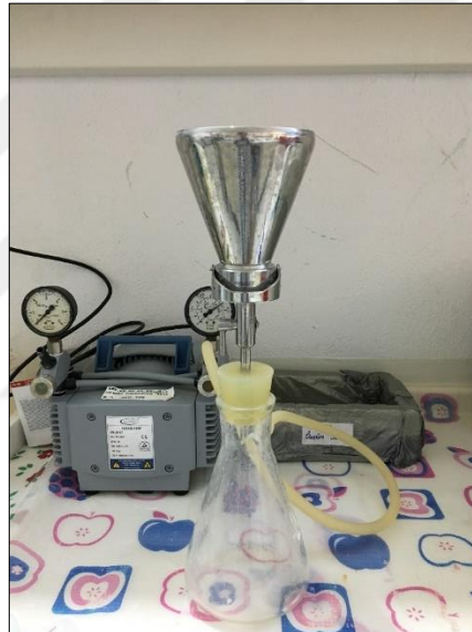
Şekil 3.14. Diyafram pompası ve filtrasyon seti
