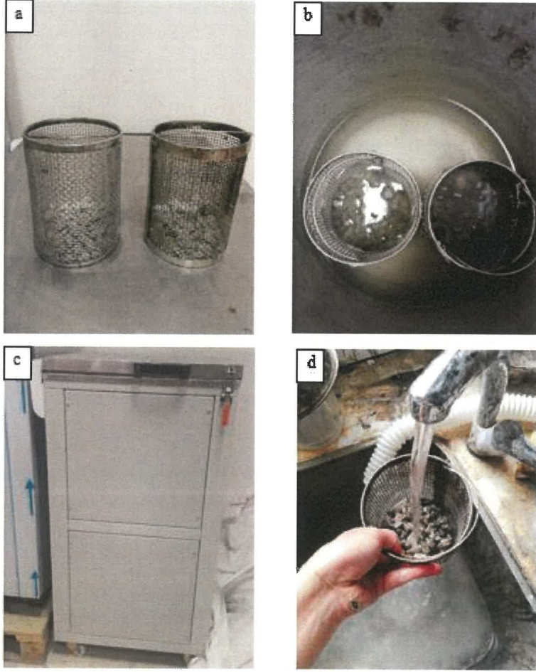
Şekil 3.7. a) Numunelerin tel sepetlere konulması; b) Tel sepetlerin magnezyum sülfat çözeltisine konulması; c) Magnezyum sülfat çözeltisi kabın su banyosunda bekletilmesi; d) Deney sonucunda numunelerin magnezyum sülfat çözeltisinden arındırılması için yıkanması
