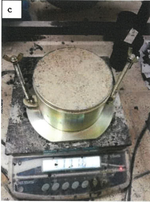
Şekil 3.9. a) Malzemelerin homojen bir şekilde karıştırılması; b) Tokmak ile sıkıştırma işlemi; c) Kalıp ile yaş numunenin ağırlığının kaydedilmesi; d) Su içeriğinin belirlenmesi için yaş numune örneklerinin etüvde kurutulması
