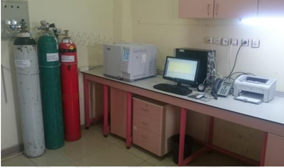
Şekil 3.3. Fosfin gazı ölçümü için kullanılan gaz kromatografi sistemi (GC)
