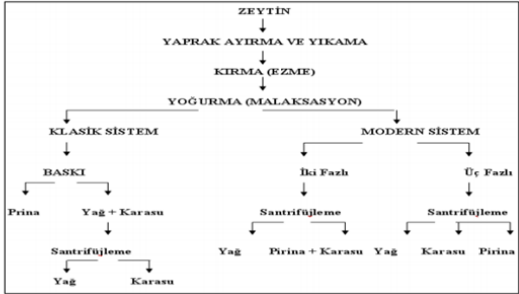
Şekil 2.3. Zeytinin üretimi ve akım şeması (Garcia, C., ve ark., 2009).
