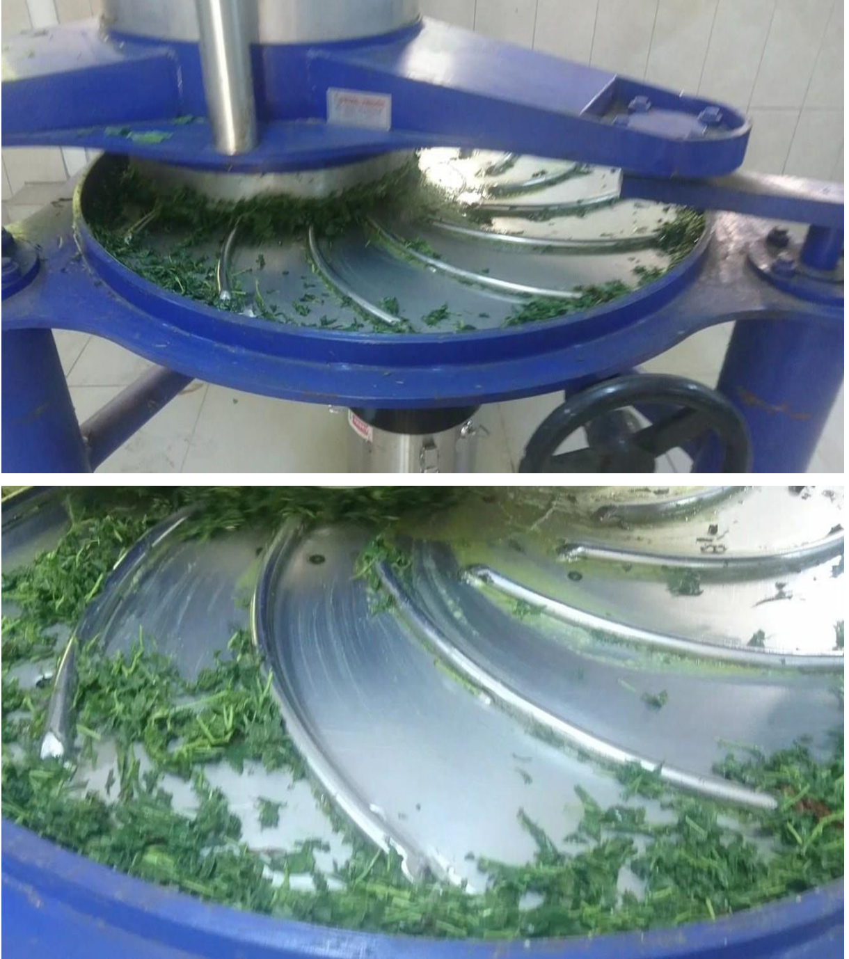
Şekil 3.3. Çay Yapraklarının Kıvrırma Ünitesinde Kıvrılması
