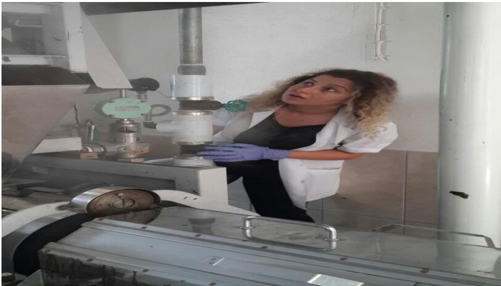
Şekil 3.1. Yaş Çay Yapraklarının Şoklama Ünitesine Beslenmesi ve Şoklanması
