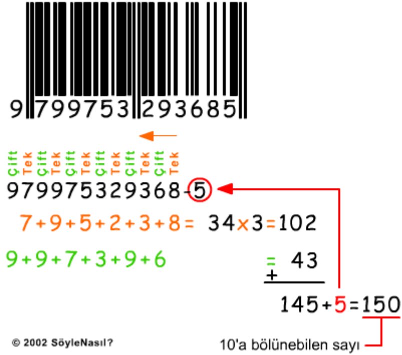
Şekil 5.4: Barkod tarayıcısının hesabı (Anonim 2007)
