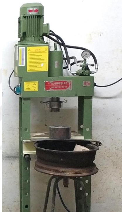
Şekil 4.9. Basınç uygulayarak MAK numunelerin preslenmesinde kullanılan hidrolik pres.
