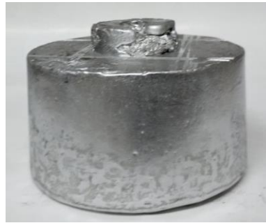
Şekil 4.14. Ergimiş metal karıştırma yöntemi ve basınç uygulayarak ılık şekillendirme ile elde edilen yarı mamul MAK numuneye ait görüntü.
