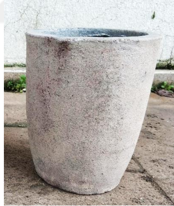
Şekil 4.11. Karıştırma döküm işleminde kullanılan grafit malzemedен yapılmış pota görüntüsü.
