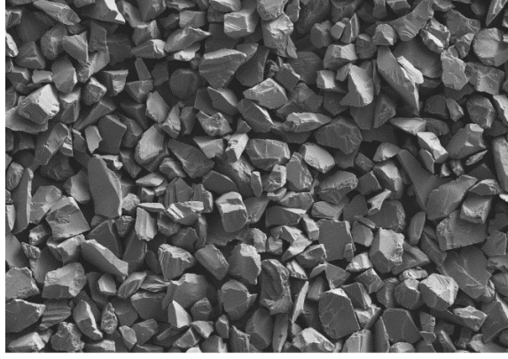
Şekil 4.2. 500x büyütülmüş SiC parçacıkları görüntüsü.
