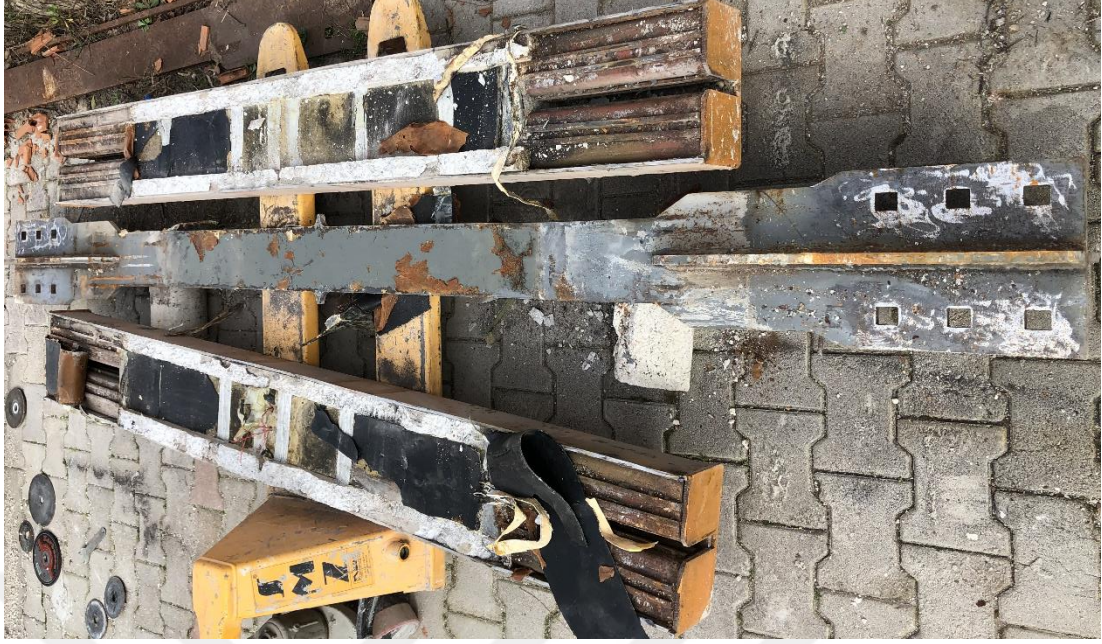
Şekil 4.13. Deney sonrası 2.BEÇÇ elemanda meydana gelen deformasyonlar
