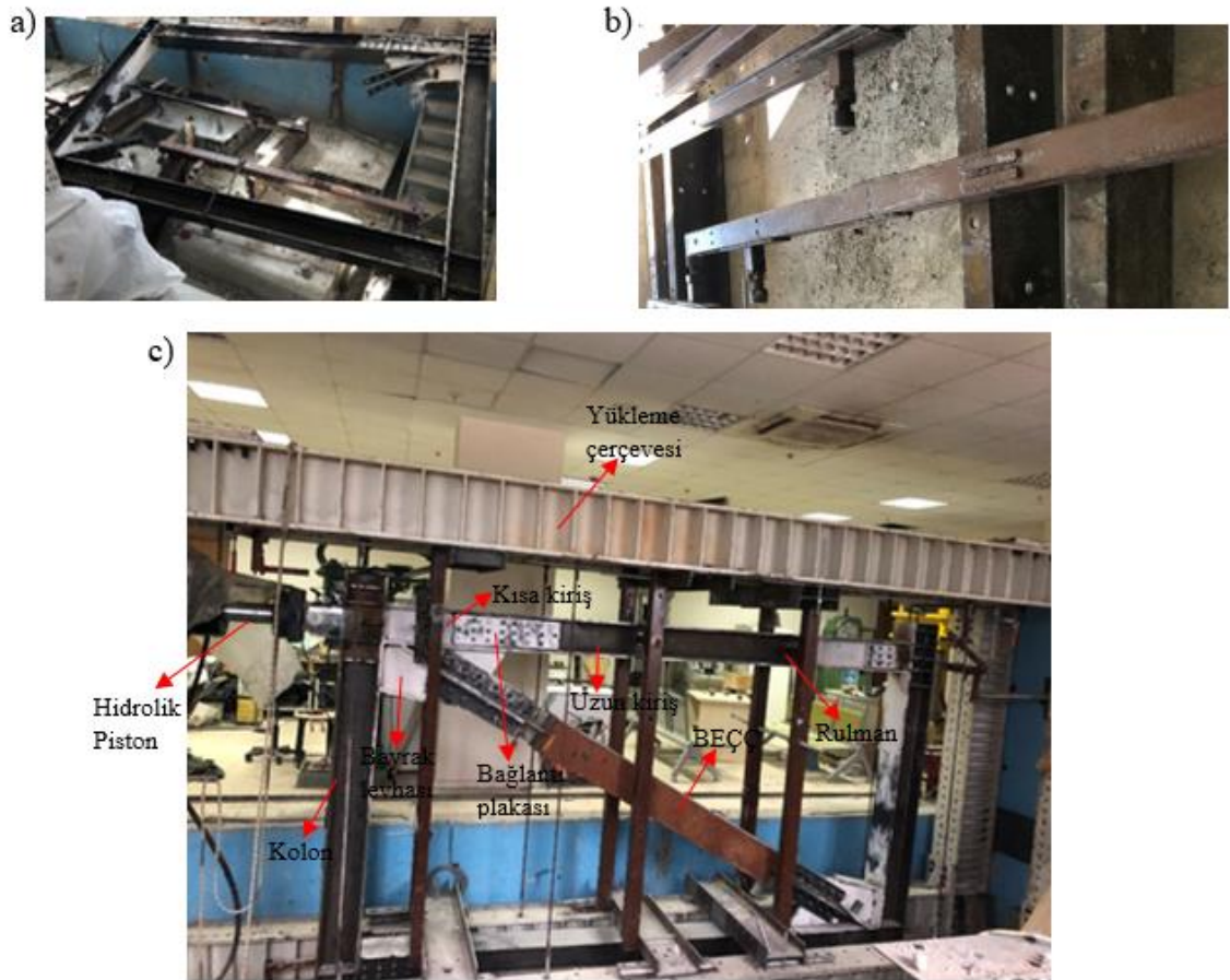
Şekil 3.17. a) Çerçeve sistem; b) Düzlem dışı hareketi önleyen mekanizma; c) Deney düzeneği
