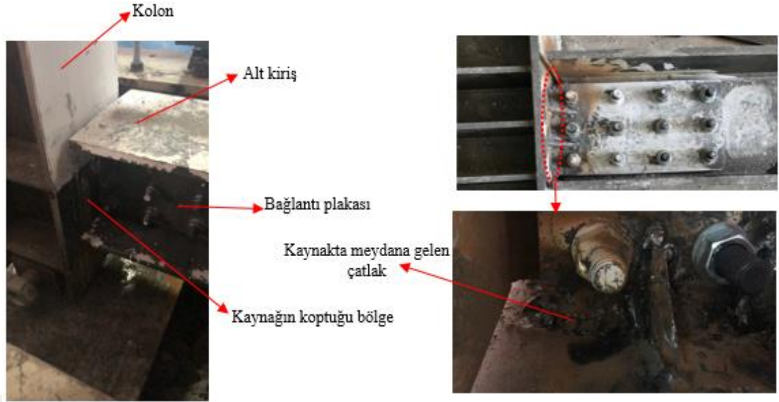
Şekil 4.18. Deney sonrası çerçeve sistemde meydana gelen hasarlar
