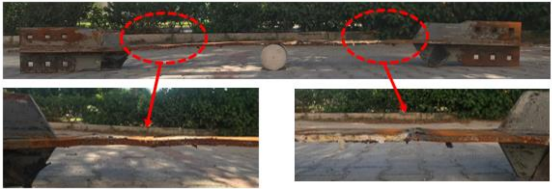
Şekil 4.19. Deney sonrası 3.BEÇÇ elemanda meydana gelen deformasyonlar
