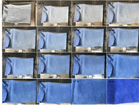
Şekil 4.96. P(MMA-ko-MA)/TS1-1 kodlu mikrokapsüllerin uygulandığı Pamuk-3 kodlu kumaşın farklı sıcaklıkta alınan fotoğrafları
