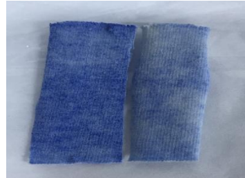
Şekil 4.139. Arakril SB81 ile mikrokapsül uygulanmış kumaşların yıkama öncesi (soldaki) ve sonrası (sağdaki) görüntüleri
