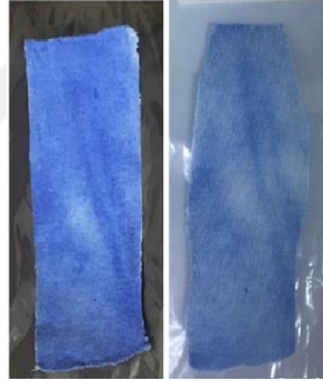
Şekil 4.134. BTCA ile mikrokapsül uygulanmış kumaşların yıkama öncesi (soldaki) ve sonrası (sağdaki) görüntüleri
