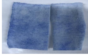
Şekil 4.138. Arakril AT546 ile mikrokapsül uygulanmış kumaşların yıkama öncesi (soldaki) ve sonrası (sağdaki) görüntüleri
