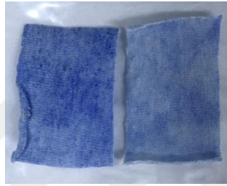
Şekil 4.141. Arakril AT571 E ile mikrokapsül uygulanmış kumaşların yıkama öncesi (soldaki) ve sonrası (sağdaki) görüntüleri
