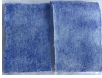
Şekil 4.140. Arakril AT111 ile mikrokapsül uygulanmış kumaşların yıkama öncesi (soldaki) ve sonrası (sağdaki) görüntüleri
