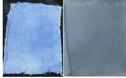
Şekil 4.142. Fiksator uygulama sonrası kendi halinde kurumaya bırakılan kumaşın yıkama öncesi (soldaki) ve sonrası (sağdaki) görüntüsü
