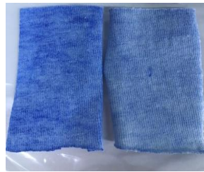
Şekil 4.144. Emdirme yöntemiyle fiksator uygulanmış kumaşın yıkama öncesi (soldaki) ve sonrası (sağdaki) görüntüsü
