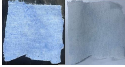
Şekil 4.142. Fiksator uygulama sonrası kendi halinde kurumaya bırakılan kumaşın yıkama öncesi (soldaki) ve sonrası (sağdaki) görüntüsü
