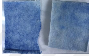
Şekil 4.137. Setacross BC çapraz bağlayıcı ile mikrokapsül uygulanmış kumaşların yıkama öncesi (soldaki) ve sonrası (sağdaki) görüntüleri
