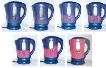
Şekil 1.5. Su ısıtıcısının sıcaklığa bağlı gösterdiği renk değişimi (Talbot, 2003)
