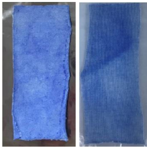
Şekil 4.135. Sitrik asit ile mikrokapsül uygulanmış kumaşların yıkama öncesi (soldaki) ve sonrası (sağdaki) görüntüleri
