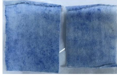
Şekil 4.136. Setabinder F8 akrilik binder ile mikrokapsül uygulanmış kumaşların yıkama öncesi (soldaki) ve sonrası (sağdaki) görüntüleri
