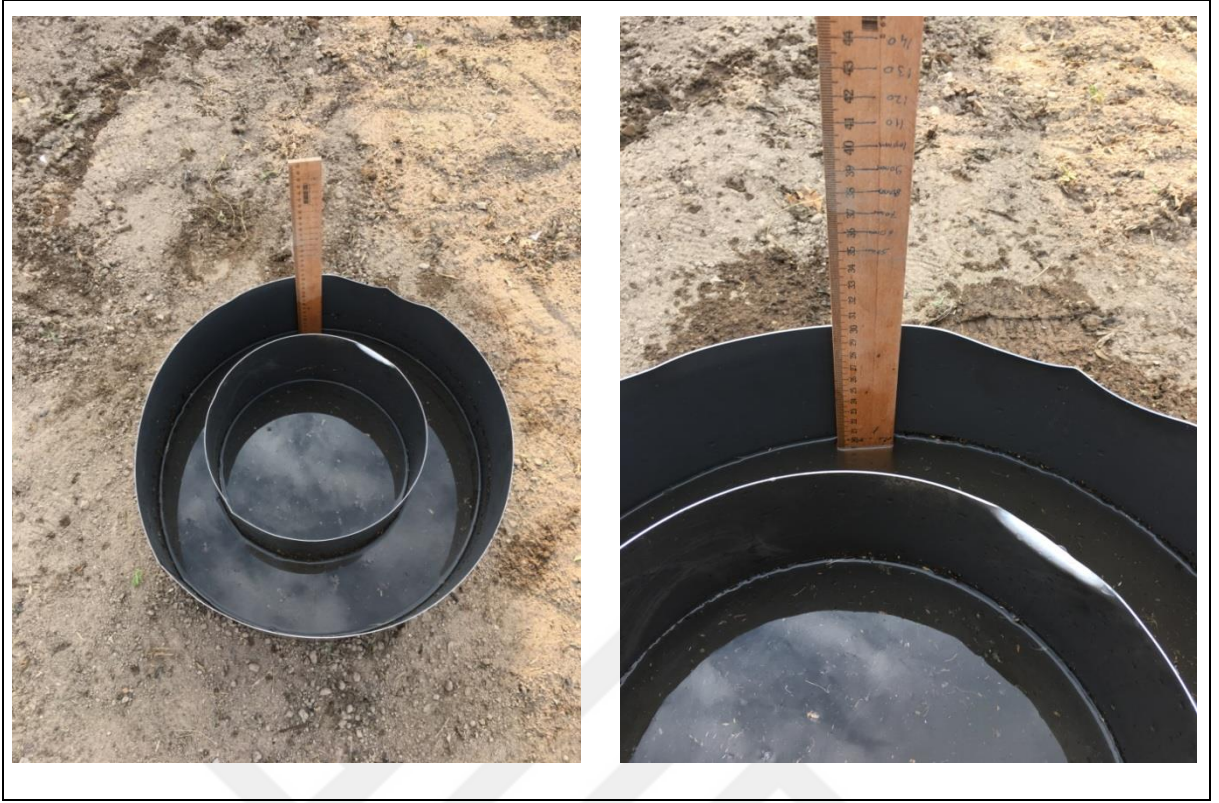
Şekil 3.4. Su ile doldurulmuş çift silindirli infiltrometre
