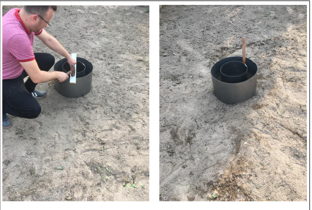
Şekil 3.3. İnfiltrometrenin ölçüm için hazırlanması
