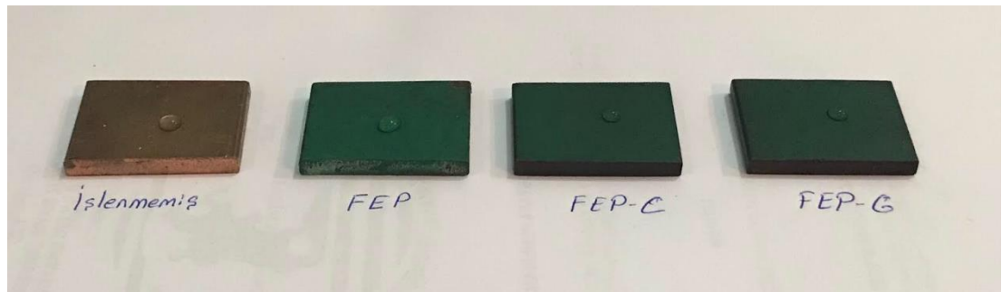
Şekil 3.5. İşlenmemiş bakır plaka ve FEP, FEP-C ve FEP-G ile kaplı plakalar
