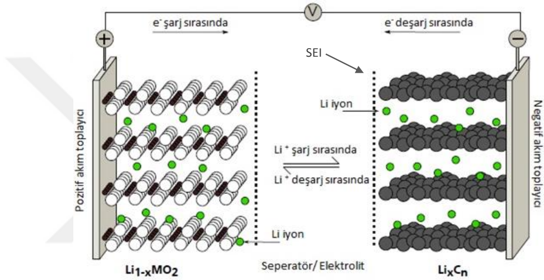
Şekil 1.2. Li-iyon pillerde şarj/deşarj işleminin şematik gösterimi
