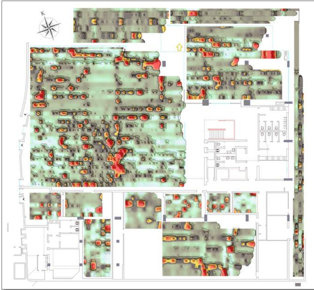
Şekil 4.6 : Yapı altında sığ kotlarda (-3.5m - -3.7m) yoğunluk haritası ve yapı bodrum kat planı
