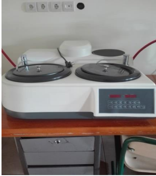
Şekil 3.5. Zımparalama ve parlatma makinesi
