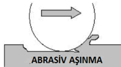
Şekil 2.14. Abrasiv aşınma mekanizması
