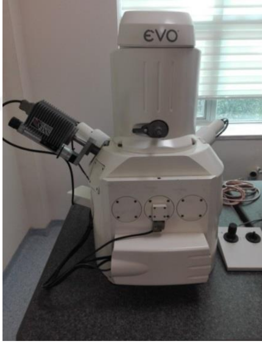
Şekil 3.4. ZEISS marka Evo 50 model taramalı elektron mikroskobu (SEM)
