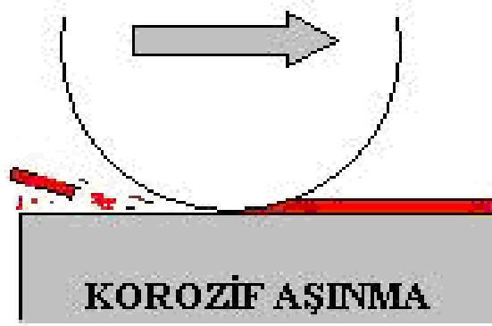
Şekil 2.18. Koroziif aşınma mekanizması
