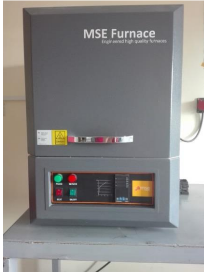
Şekil 3.1. Kutu tipi yüksek sıcaklık sinterleme fırını
