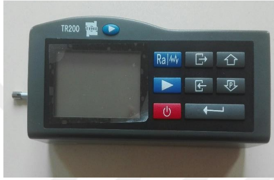
Şekil 3.8. Time TR 200 model profilmetre cihazı
