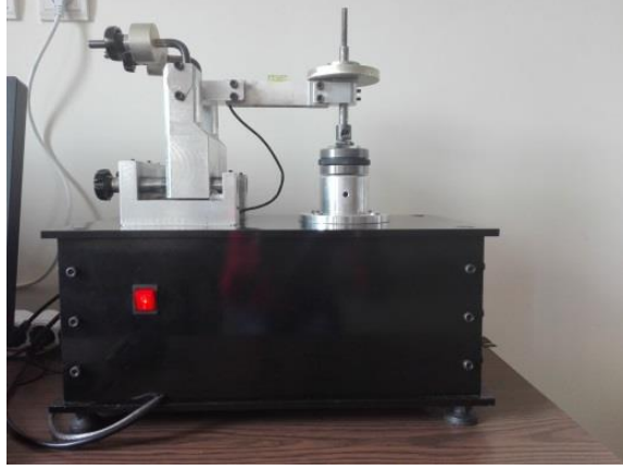
Şekil 3.6. TRD marka pin-on-disk aşınma test cihazı
