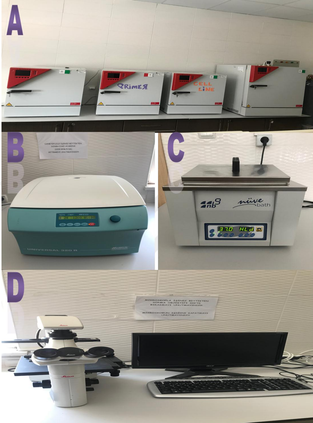
Şekil 2.7. A) MCF-7 Hücre kültüründe kullanılan cihazlar; (A) inkübatör, (B) santrifüj, (C) su banyosu (D) invert mikroskop
