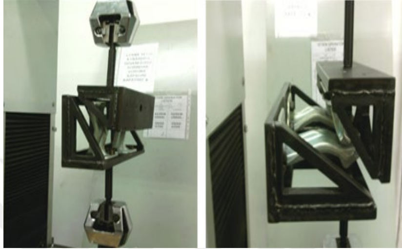
Şekil 8.6. Çekme test cihazında çekilen menteşeler.
