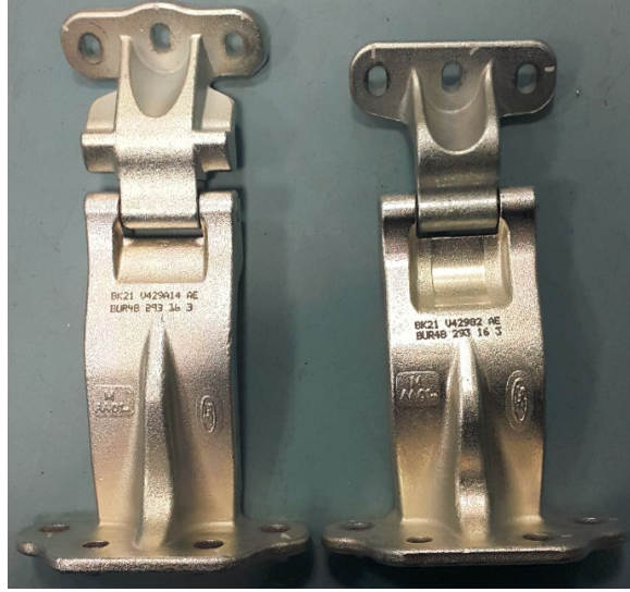
Şekil 8.2. Efor ölçümü yapılan çelik menteşeler.
