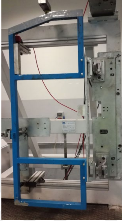
Şekil 8.13. Arka kapı çarparak hızlı açma kapama menteşe ömür testi.
