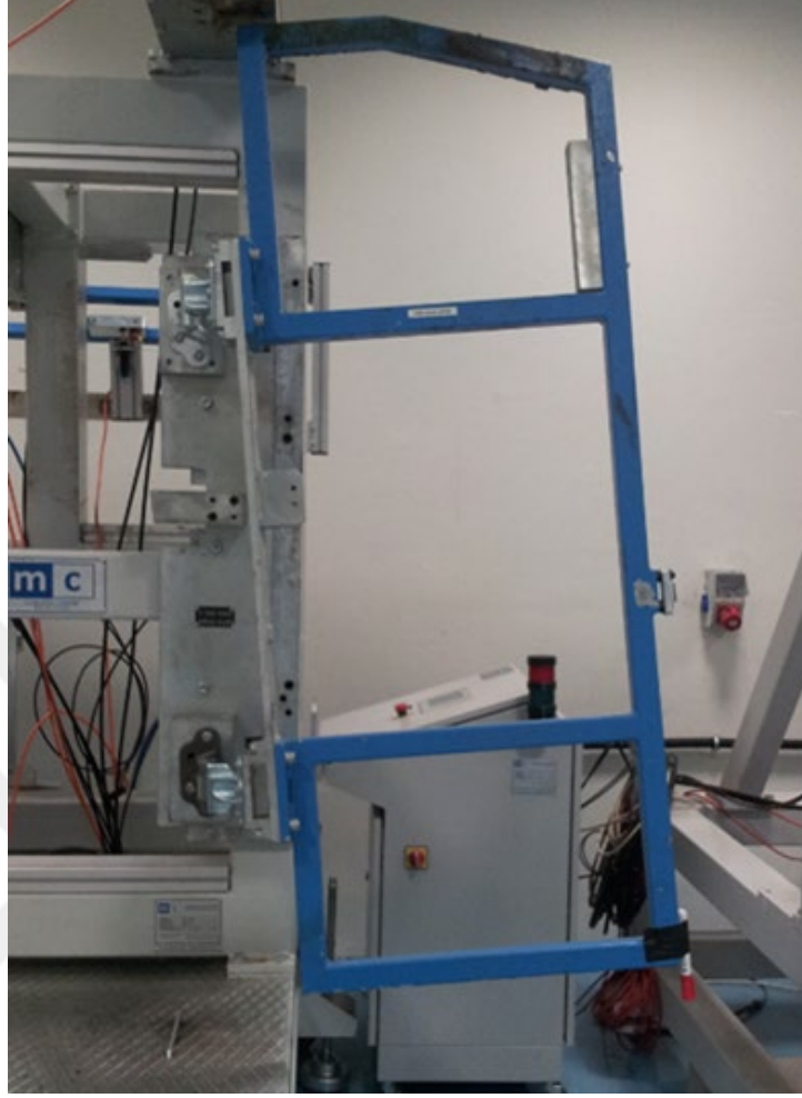
Şekil 8.3. Tam açık pozisyonda yatay aşırı yükleme testi.
