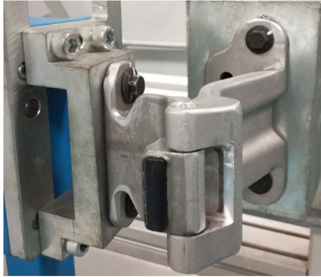
Şekil 8.1. Mentşe efor ölçüm için bankoya bağlantısı.
