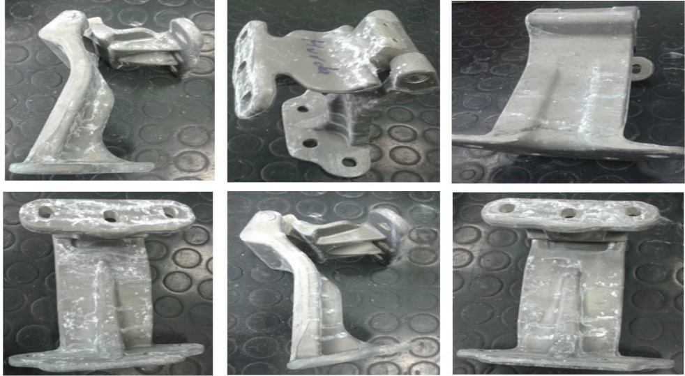
Şekil 8.1. Elokmal ile kaplanan 7XXX serisi alüminyum menteşeler
