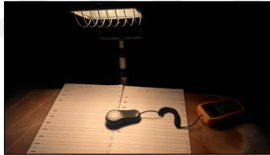
Şekil 3.23. 300 Watt 1760 Lüks ksenon lamba kullanılarak 30 cm mesafede ışık kaynağına maruz bırakılan mürekkep örnekleri
