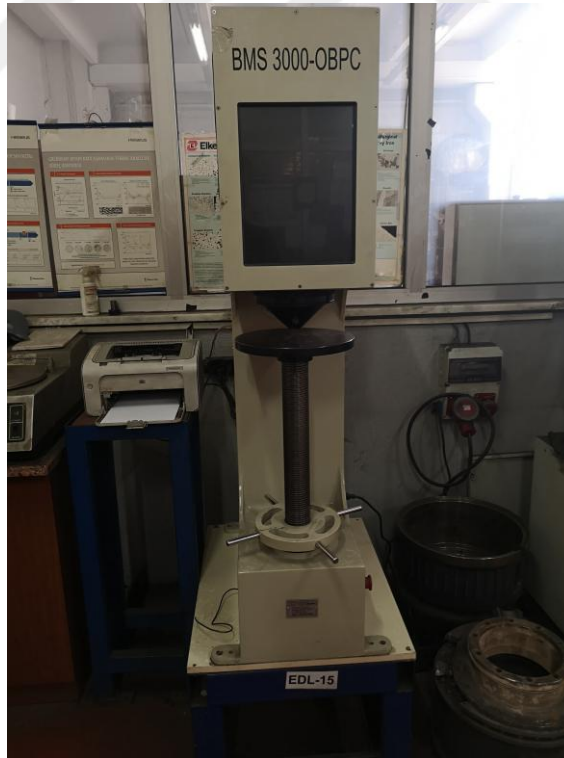
Şekil 3.4. Brinell Sertlik Cihazı
