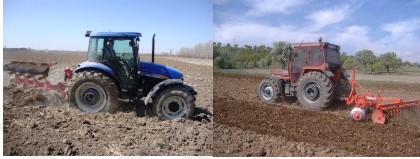
Şekil 1.4. Tarlanın pullukla sürülmesi ve toprak keseklerinin diskaro ile parçalanması
