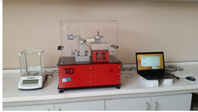
Şekil 6.11. TRDWear aşınma test cihazı.
