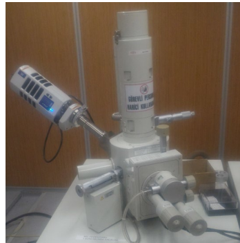
Şekil 6.16. JEOL JSM 5600 taramalı elektron mikroskobu (SEM) cihazı.
