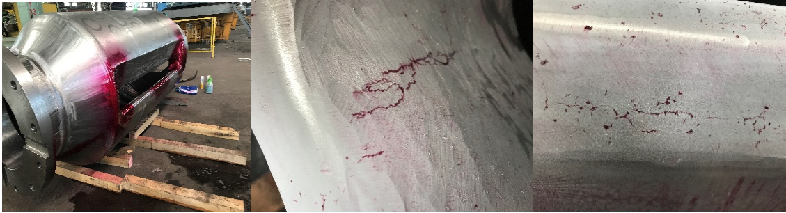
Şekil 5.4. PT metodu ile tespit edilen hata örnekleri.
