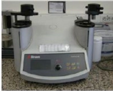
Şekil 6.13. Struers Citopress-20 model otomatik bakalit alma cihazı.
