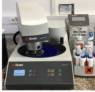
Şekil 6.14. Struers TegraPol-21 zımpara- Struers-Tegra Force 5 parlatma cihazı.
