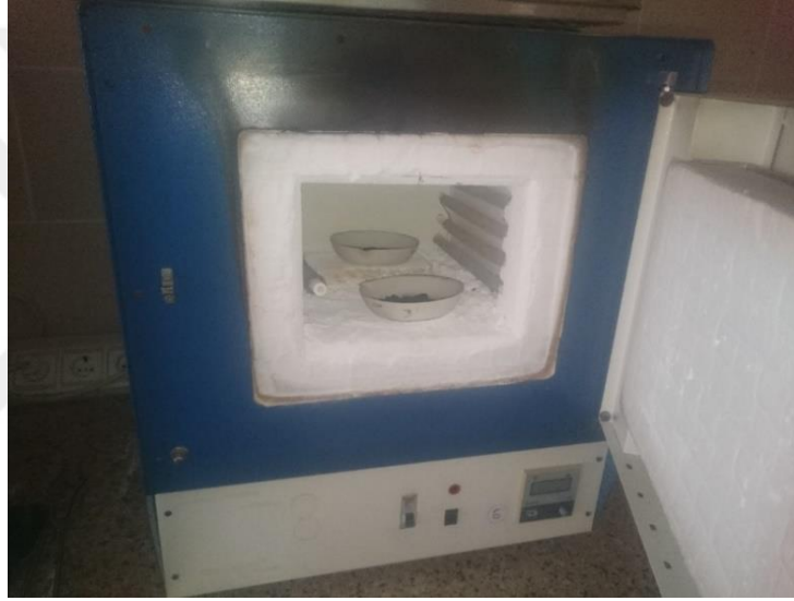
Resim 3.7 4 saat boyunca 650 °C kül fırınında ısıya maruz bırakılan numuneler.
