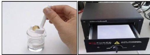
Şekil 3.8: Kuartz sensöre uygulanan kimyasal ön işlem ve kullanılan uv/ozon sistemine ait gösterim.
