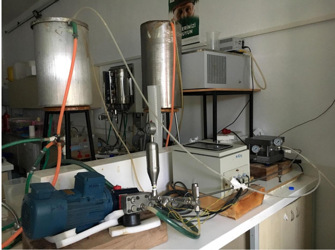
Şekil 3.1. SEPA CF II, Osmonics membran test ünitesi
