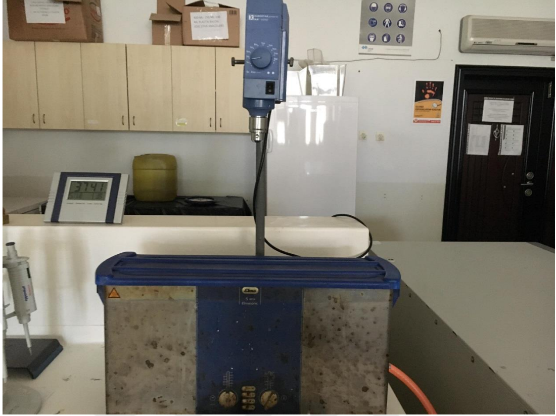
Şekil 3.3. IKA Labortechnik RW 20 DZM ve Elma Elmasonic S80H Ultrasonik cihazları.
