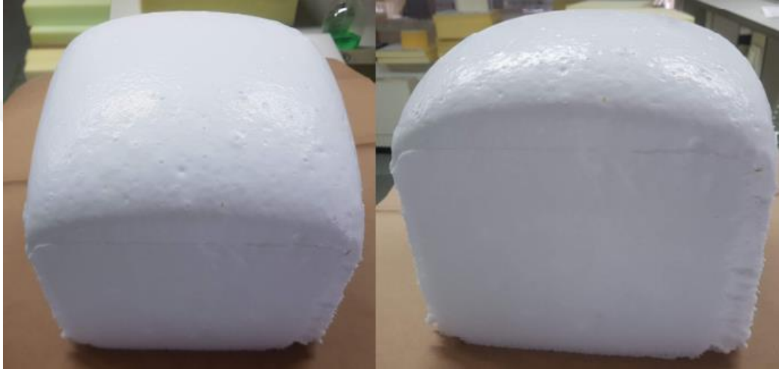
Şekil 5.2 Bitkisel yağ bazlı poliolden elde edilen sünger
