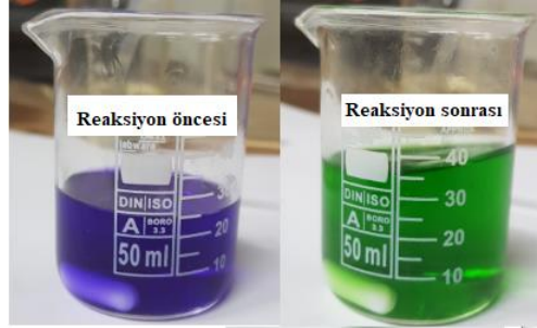
Şekil 4.8 Oksiran oksijen % belirlemede renk değişimi
