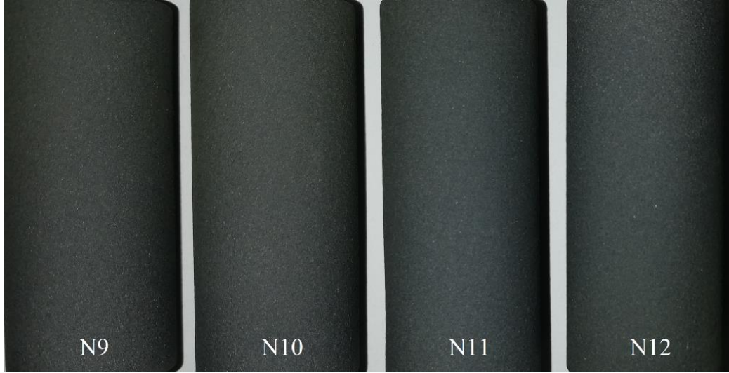
Şekil 6.3. \text{Cr}_2\text{O}_3 -40 \text{TiO}_2 kaplanmış numunelerin makro fotoğrafları
