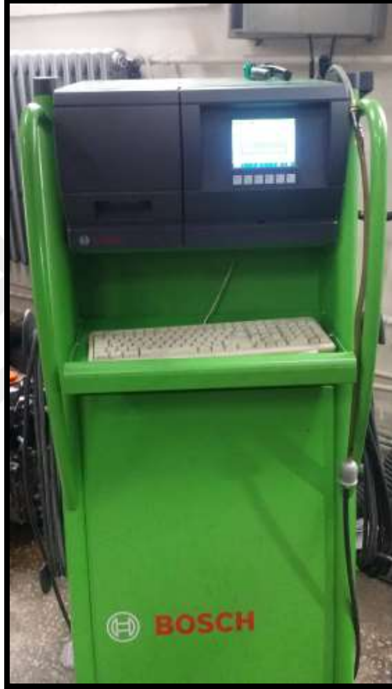
Şekil 5.3 Bosch marka emisyon ölçüm cihazı
