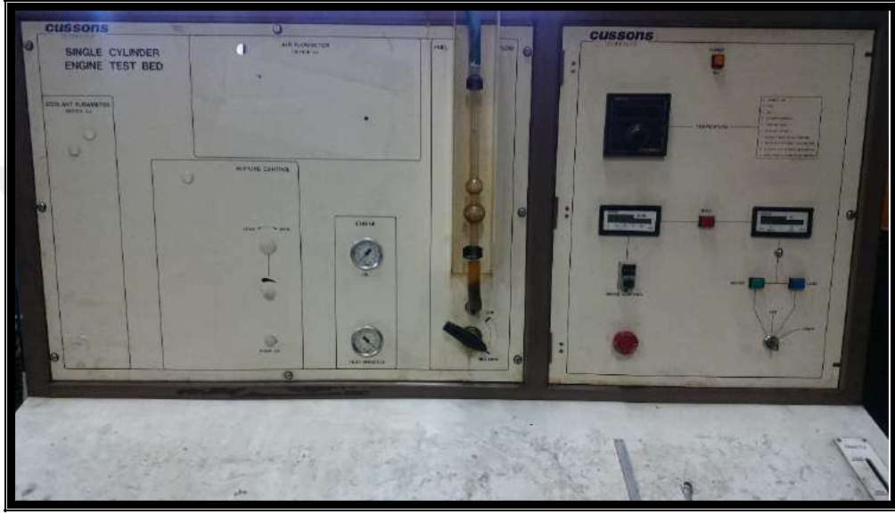
řekil 5.1 Cussons P8160 motor test düzeneđi
