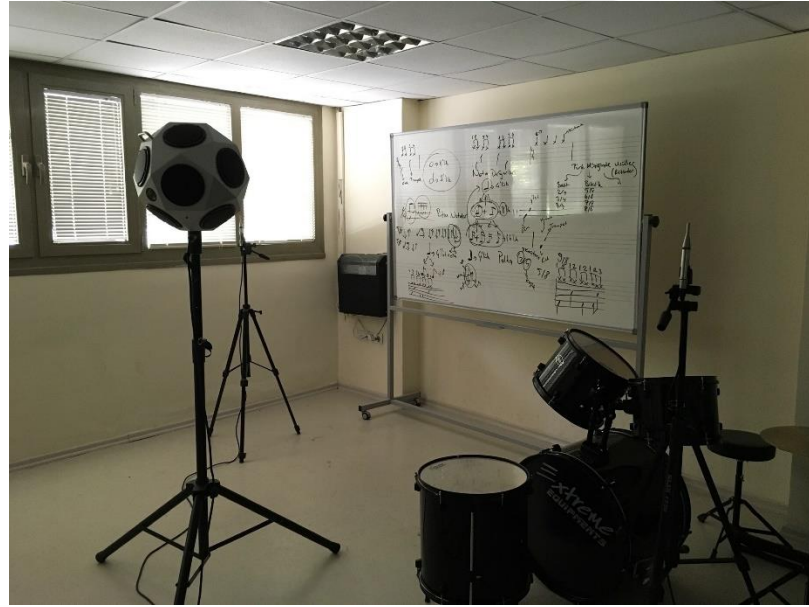
Şekil 31- Kaynak Oda Mikrofon Konumları Yerinde Gösterimi (C. Daloğlu arşivi)
