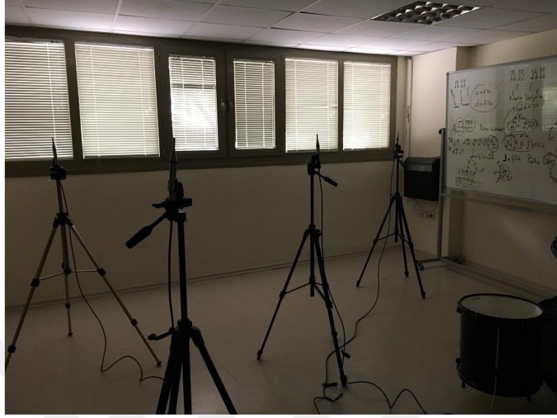
Şekil 30- Alıcı Oda Mikrofon Konumları Yerinde Gösterimi (C. Daloğlu arşivi)
