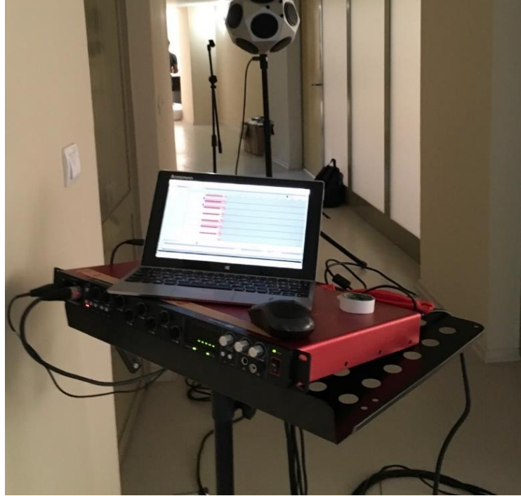
Şekil 24- Yerinde Ölçüm Sistemi için bir örnek (C. Daloğlu arşivi)
