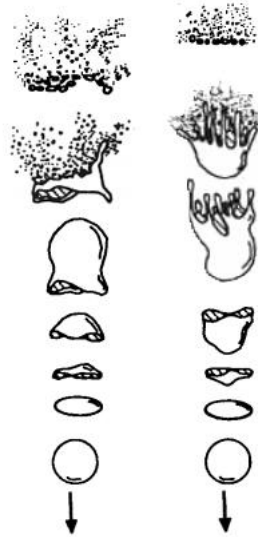
Şekil 2.18. Damlacık parçalanma modları; solda: torba parçalanma; sağda: doğrudan parçalanma (Kennedy and Roberts, 1990).
