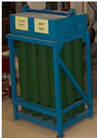
Şekil 3.13. Gaz kaynağı olarak kullanılan 12'li azot paleti.
