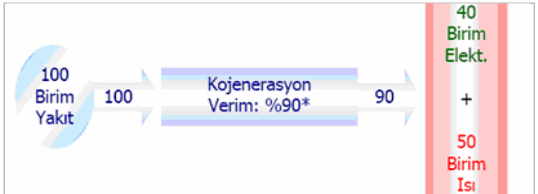
Şekil 1.6. Klasik bir kojenerasyon sisteminin üretim şeması
